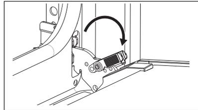
3. Schließen Sie die Backofentür halb bis zur ersten Öffnungsstellung. Anschließend heben und ziehen Sie die Tür aus der Aufnahme heraus.
