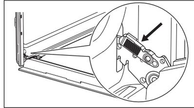
2. Heben und ziehen Sie die Verriegelungen an, bis sie einrasten.
