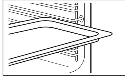
Schieben Sie das Backblech zwischen die Führungsstäbe der Einhängegitter. Platzieren Sie das Backblech mit Gefälle zur Rückseite des Backofeninnenraums.
