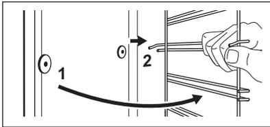
4. Setzen Sie die Einhängegitter in umgekehrter Reihenfolge ein. Die Haltestifte an den Teleskopplüfern müssen nach vorne zeigen.
